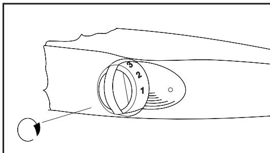
**(i)** При установке термостата в положение „5” (на максимум) в случае увеличения нагрузки на прибор, например, во время жары - компрессор может работать постоянно. Это не вызовет никакого сбоя в работе прибора.
